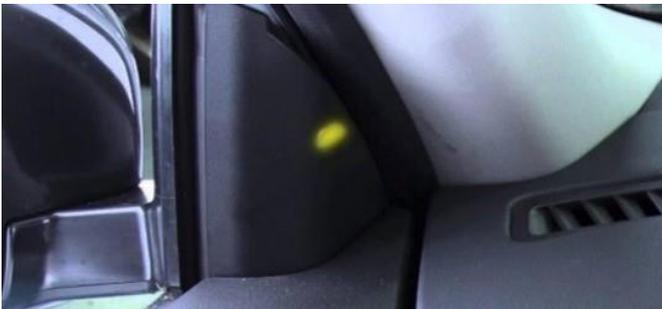
Si le véhicule est équipé de la fonction d'angle mort, le rétroviseur extérieur porte normalement une lampe spécifique qui avertit le conducteur si un véhicule s'approchant par l'arrière se trouve dans l'angle mort. Avec le diagnostic, il est possible d'identifier le système d'angle mort par des contrôles globaux, le système est composé de deux radars moyens/courts positionnés sur les côtés du pare-chocs arrière ou des deux caméras positionnées sous les
