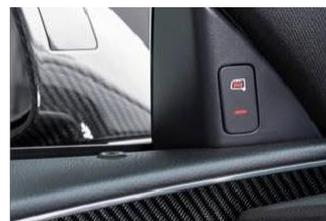
L'assistance aux angles morts calcule la position, la distance et le sens de la marche des autres véhicules et émet un avertissement en cas de véhicules circulant sur les voies adjacentes. Le système facilite le changement de voie et prévient les accidents. Les systèmes BSD (Blind Spot Detection) fonctionnent par défaut avec des capteurs radar situés des deux côtés du véhicule, capteurs qui peuvent également être utilisés pour les aides au stationnement et pour le système Park In Assist.
