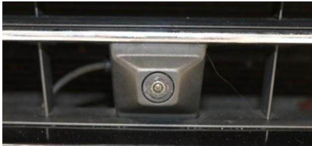
Avec l'outil de diagnostic, il est possible d'identifier si le système de caméra frontale est installé, en effectuant un contrôle global.
