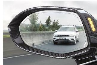
Le terme "angle mort" désigne la zone qui, malgré les rétroviseurs latéraux et arrière, n'est pas visible par le conducteur pendant un court instant. Il s'agit généralement des véhicules qui suivent ou de ceux qui sont en train de dépasser par la gauche.
